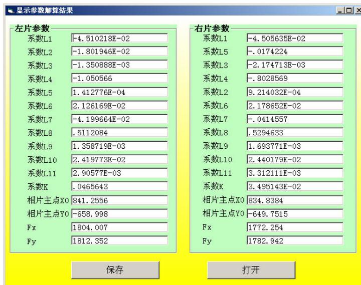
图 4-6 DLT 参数解算结果
