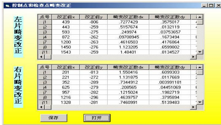
图 4-7 控制点和检查点像片坐标的畸变改正结果
