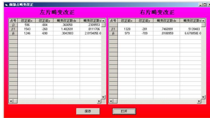
图 4-8 碎部点像片坐标的畸变改正结果
