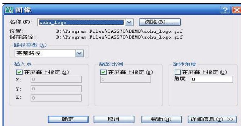
“名称”栏中为上一步中所选图像文件名，按“浏览”键则回到上一对话框重选插入图像，“插入点”栏中为图像插入点，“缩放比例”栏中为图像的比例因子，“旋转角度”栏中为图象旋转角。若在“在屏幕上指定”前边的小方框内打√，则此项图形参数栏就会变为灰色，其参数随后将依命令区提示要求输入。
